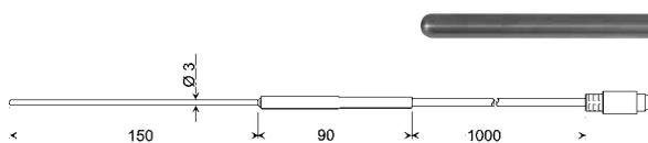
rostbeständiges V4A-Rohr Ø 3 mm, Schrumpfschlauch, ca. 1 m 4-pol. PVC-Kabel, 4-pol. Mini-DIN-Stecker
