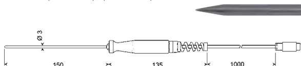
V4A-Rohr Ø 3 mm mit nadelförmige Einstechspitze, Kunststoffhandgriff, Knickschutzverschraubung, ca. 1 m 4-pol. PVC-Kabel, 4-pol. Mini-DIN-Stecker
