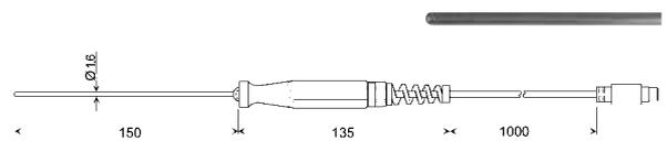
V4A- Mantelrohr biegsam, Ø 1,6 mm, Kunststoffhandgriff, Knickschutzverschraubung, ca. 1 m 4-pol. PVC-Kabel, 4-pol. Mini-DIN-Stecker
